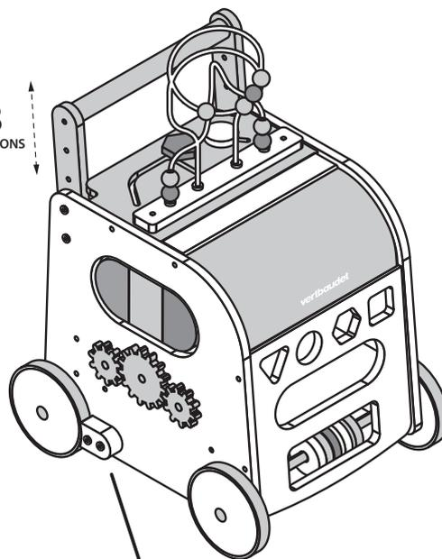
Le frein permet de bloquer les roues quand l'enfant commence juste à se lever. Ajuster ensuite la pression sur la roue en fonction du freinage désiré lors des premiers pas. Toujours resserrer fortement les vis.
